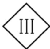
Un apparecchio viene definito di Classe III quando la protezione contro la folgorazione si affida al fatto che non sono presenti tensioni superiori alla Bassissima tensione di sicurezza SELV (Safety Extra-Low Voltage). In pratica tale apparecchio viene alimentato o da una batteria o da un trasformatore SELV.
