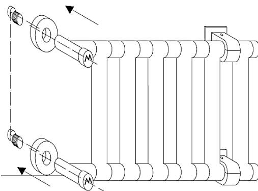
4- Dopo aver appoggiato l'articolo alla parete segnare le posizioni per gli attacchi a muro superiori/ After placing the article on the wall, mark the positions for the upper wall connections/ После помещения изделия на стену отметьте положение для верхних стенных соединений.
