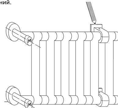
5- Smontare l'articolo, forare ed inserire i tasselli in dotazione/ Remove the item, drill and insert the supplied dowels/ Снимите деталь, сверлите и вставьте прилагаемые дюбели.
