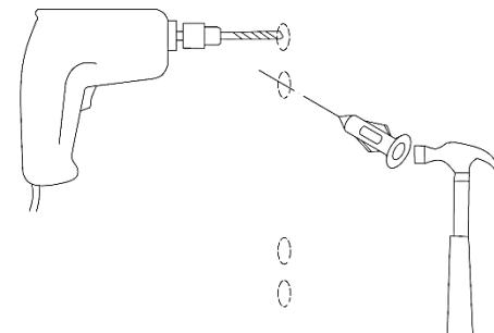
6- Fissare gli attacchi a muro con le viti in dotazione/ Attach the wall mountings to the supplied screws/ Прикрепите настенные крепления к прилагаемым винтам.
