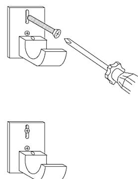
7- Avvicinare l'articolo, serrare i rubinetti, mandare a battuta il cappuccio scorrevole e serrare l'apposita vite/Attach the article, tighten the taps, slice the sliding cap and tighten the special screw/ Прикрепите изделие, затяните краны, отрежьте скользящую крышку и затяните специальный винт
