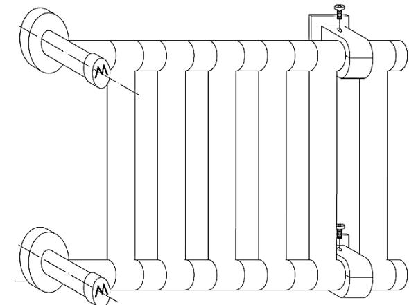
8- Sfiatare, anche più volte fino al corretto riscaldamento, agendo sugli sfiati superiori/ Breathe, even several times until proper heating, by acting on the upper vent/ Дышите, даже несколько раз, до надлежащего нагрева, действуя на верхнее отверстие
