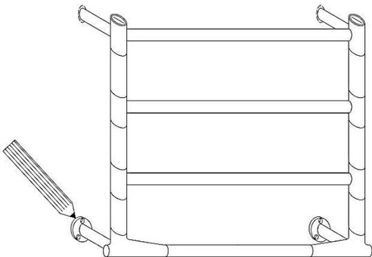
6- Eseguire il collegamento elettrico e fissare l'attacco (**Attenzione! Assicurarsi di essere scollegati dalla rete**)/ Make the electrical connection and fix the connection (**Caution! Be sure to be disconnected from the mains**)/ Сделайте электрическое соединение и зафиксируйте соединение (**Внимание! Обязательно отсоединяйте от сети**).
