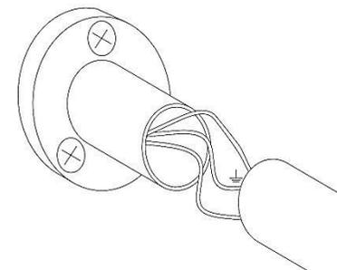
7- Fissare l'articolo e serrare le viti a grano in modo parallelo alla parete (**Attenzione! Solo dopo questa operazione si può riattivare la rete elettrica**)/ Fasten the article and tighten the grain screws parallel to the wall (**Attention! Only after this operation you can turn on the power supply**)/ Закрепите изделие и затяните винты для зерна параллельно стене (**Внимание! Только после этой операции вы можете включить источник питания**)
