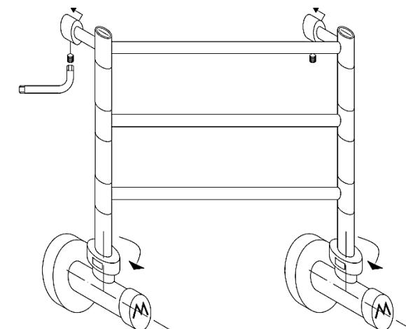
7- Sfiatare, anche più volte fino al corretto riscaldamento, agendo sugli sfiati superiori/ Breath, even several times until proper heating, by acting on the upper vent/ Дышите, даже несколько раз, до надлежащего нагрева, действуя на верхнее отверстие.
