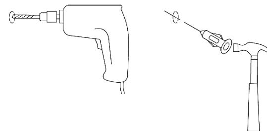
5- Fissare gli attacchi a muro con le viti in dotazione/ Attach the wall mountings to the supplied screws/ Прикрепите настенные крепления к прилагаемым винтам.
