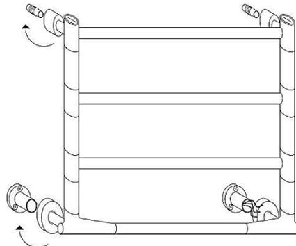
6- Eseguire il collegamento elettrico e fissare l'attacco (**Attenzione! Assicurarsi di essere scollegati dalla rete**) / Make the electrical connection and fix the connection (**Caution! Be sure to be disconnected from the mains**) / Сделать электрическое соединение и зафиксируйте соединение (**Внимание! Обязательно отсоединяйте от сети**).
