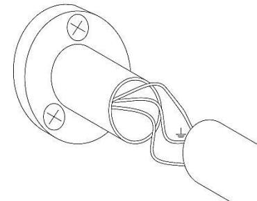
7- Fissare l'articolo e serrare le viti a grano in modo parallelo alla parete**[Attenzione! Solo dopo questa operazione si può riattivare la rete elettrica]**/ Fasten the article and tighten the grain screws parallel to the wall **[Attention! Only after this operation you can turn on the power supply]**/ Закрепите изделие и затяните винты для зерна параллельно стене **[Внимание! Только после этой операции вы можете включить источник питания]**
