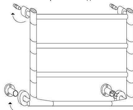
6- Eseguire il collegamento elettrico e fissare l'attacco **[Attenzione! Assicurarsi di essere scollegati dalla rete]**/ Make the electrical connection and fix the connection **[Caution! Be sure to be disconnected from the mains]**/ Сделайте электрическое соединение и зафиксируйте соединение **[Внимание! Обязательно отсоединяйте от сети]**.
