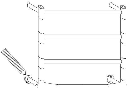
3- Eseguire i fori per inserirvi i tasselli (per ogni articolo c'è un attacco a muro specifico che potrebbe essere diverso da quelli rappresentati in questa guida)/ Run the holes to insert the dowels(for each item there is a specific wall attack that may be different from the ones shown in this guide)/ Запустите отверстия для вставки дюбелей(для каждого элемента есть конкретная атака на стене, которая может отличаться от той, что показана в этом руководстве).
