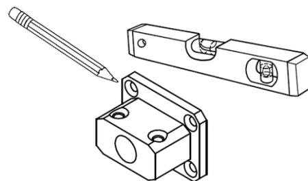
4- Eseguire i fori per inserirvi i tasselli / Run the holes to insert the dowels/ Запустите отверстия для вставки дюбелей.
