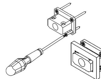
5- Avvicinare l'articolo a parete e fare il collegamento elettrico./ Bring the item to the wall and make the electrical connection./ Поднесите предмет к стене и выполните электрическое подключение.
