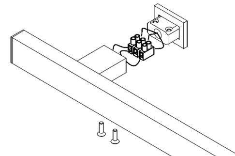
7- Fissare l'articolo con le viti in dotazione. Solo a questo punto si può accendere l'impianto elettrico./ Secure the item with the supplied screws. Only at this point can the electrical system be turned on. / Закрепите элемент прилагаемыми винтами. Только в этот момент можно включить электрическую систему.
