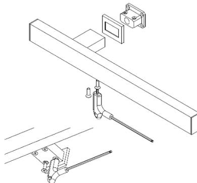
3- Avvicinare l'attacco alla parete e segnare la posizione dei supporti a muro e i relativi fori (**Usare una livella**)/ Bring the attachment closer to the wall and mark the position of the wall supports and their holes (**Use a level**)/ Поднесите насадку ближе к стене и отметьте положение настенных опор и их отверстий (**Используйте уровень**)
